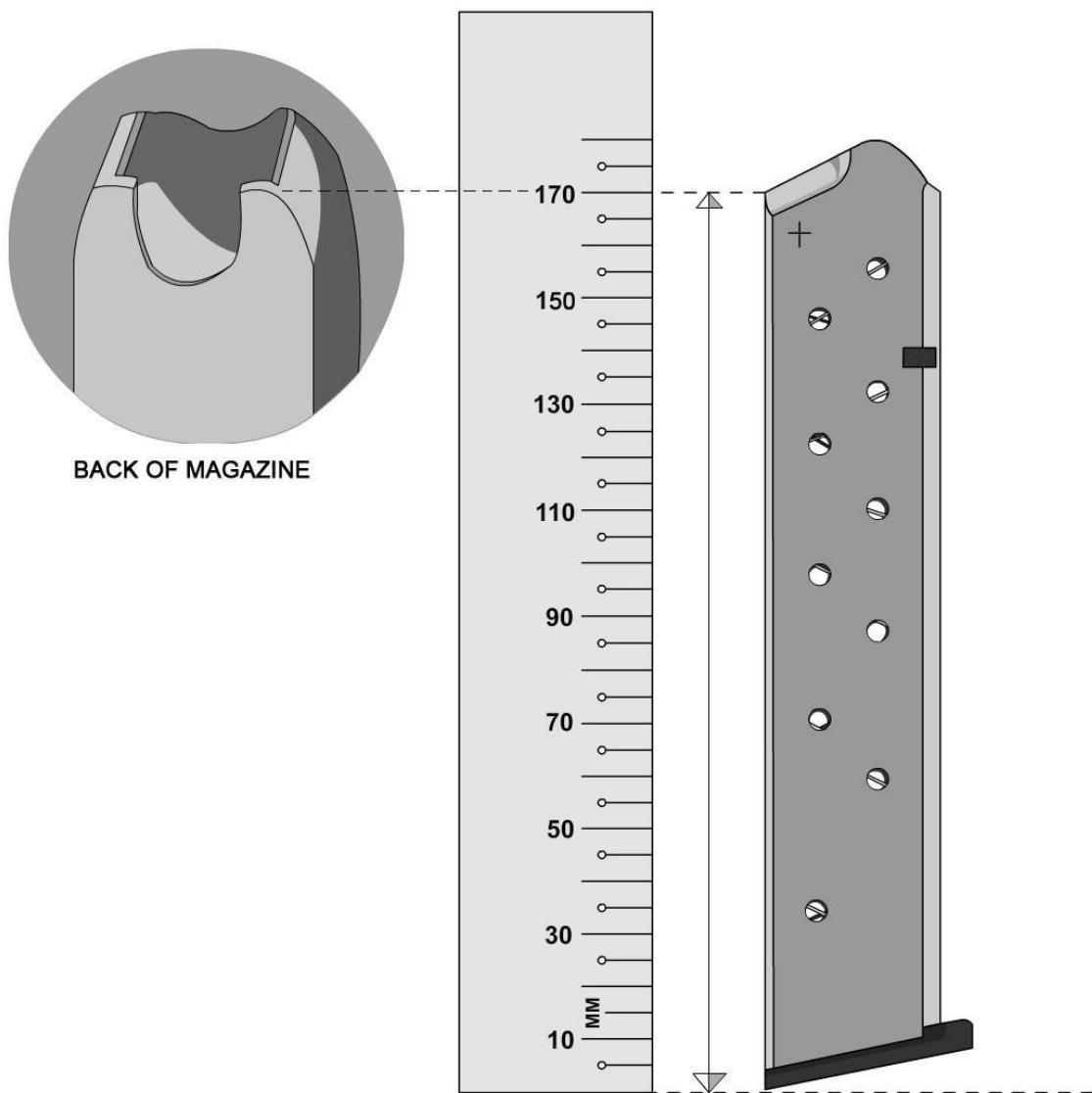
Okvir se postavlja vertikalno na ravnu površinu, a onda se meri od ravne površine do zadnjeg dela otvora za punjenje, kao na slici. Samo pravi, čvrsti okviri su dozvoljeni (fleksibilni, burence, J, L, T i slično oblikovani, nisu dozvoljeni).
